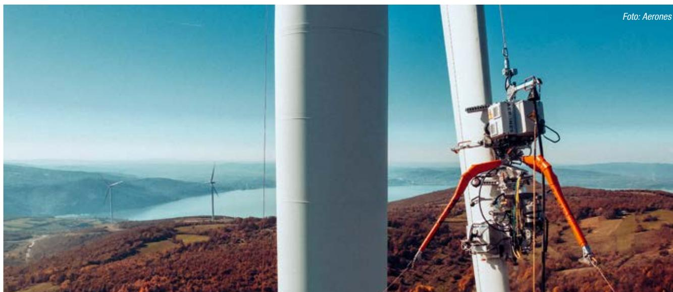
*Serviceroboter werden per Fernbedienung gesteuert*
