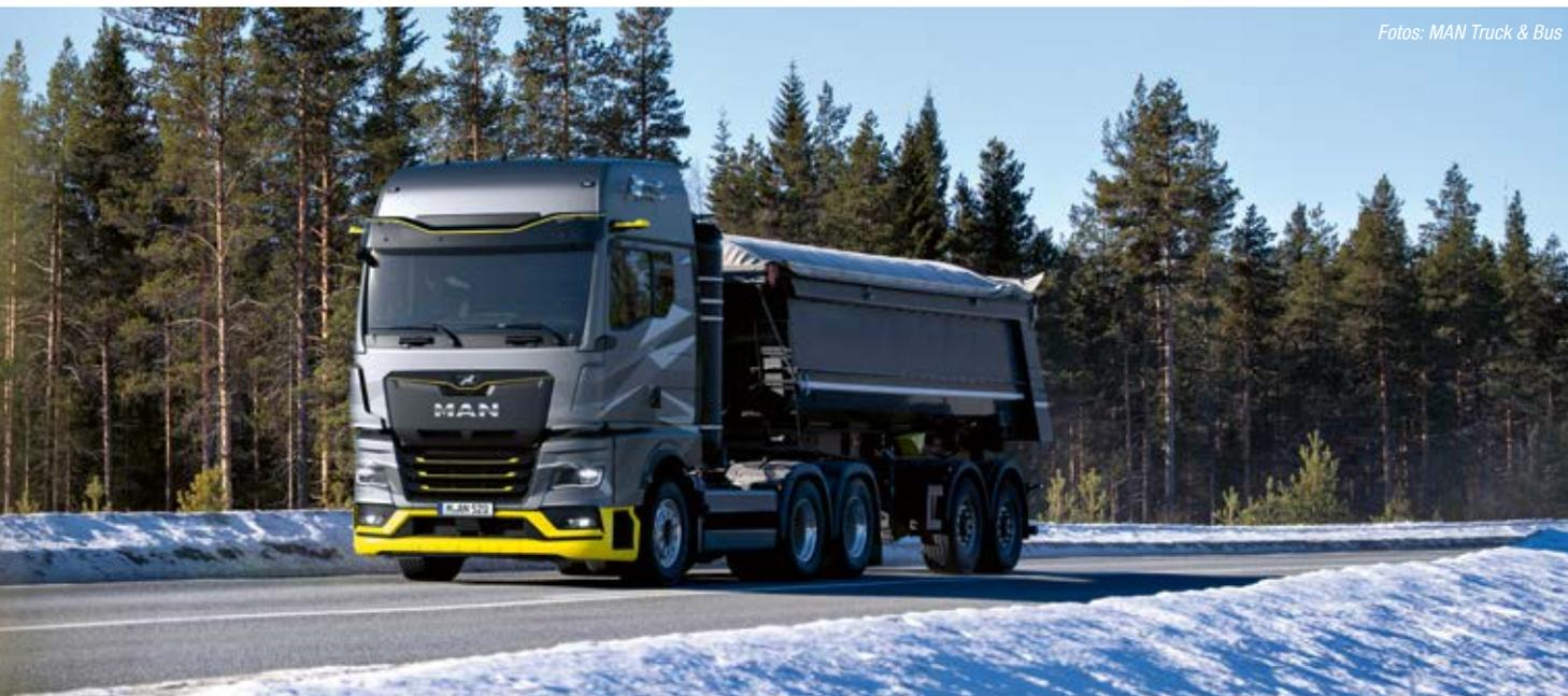
Der neue Wasserstoff-Verbrenner-Lkw basiert auf der bewährten TG-Fahrzeugreihe.
